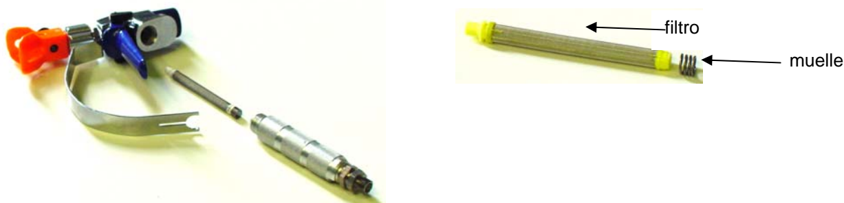
Figura 18 - Limpieza filtro pistola
